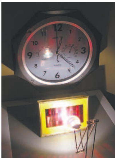
Демонстрационный лабораторный образец органической солнечной батареи, разработанный в ИПХФ РАН, которая приводит в действие настенные часы
